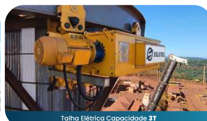
Talha Elétrica Capacidade 3T
